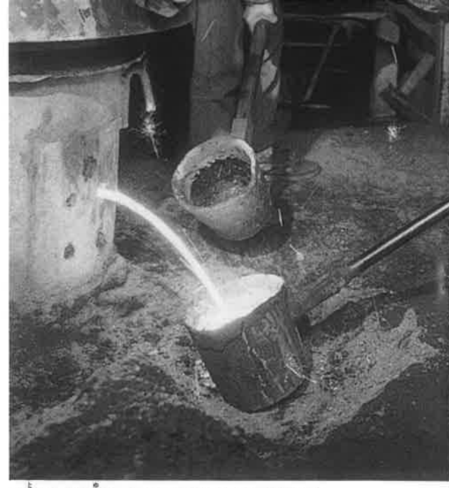
▲溶けた鉄の湯を、とりべというひしゃくで受けます。
