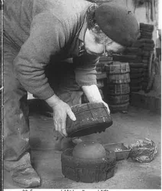
▲中子の上に鉄の小片を置き、尻型をかぶせます。
