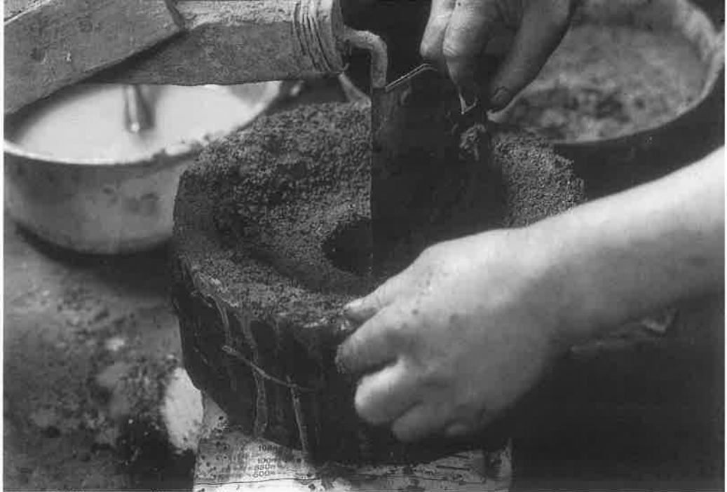
▲最初に鉄びんの胴部分の鑄型づくりから始めます。
